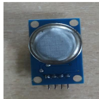
Fig 4: MQ137 Gas Sensor
