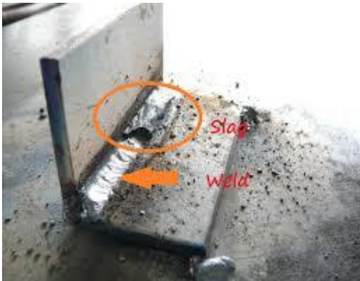
FIG 1. ARC WELDING SLAG
