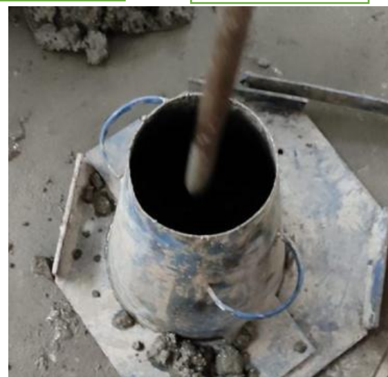
Fig:1 slump test
