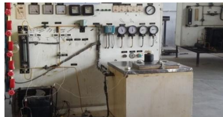
Fig. 3:- Vapor Compression Refrigeration Test Rig.
