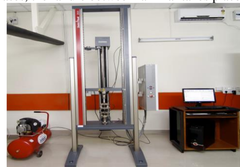
Fig. 5. ILSS testing using UTM
