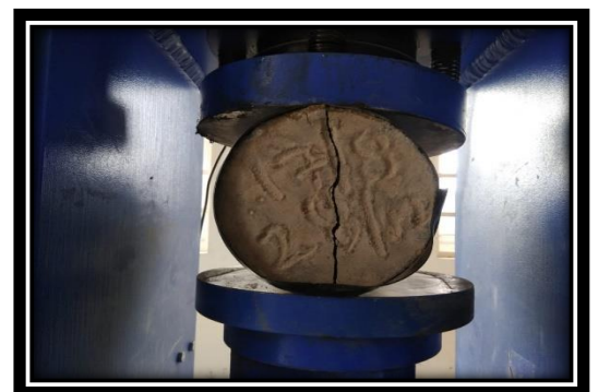
Fig.No.7.2. split tensile test
