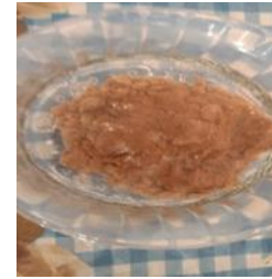
Fig 4: Sodium Bentonite + 3% Lime.
