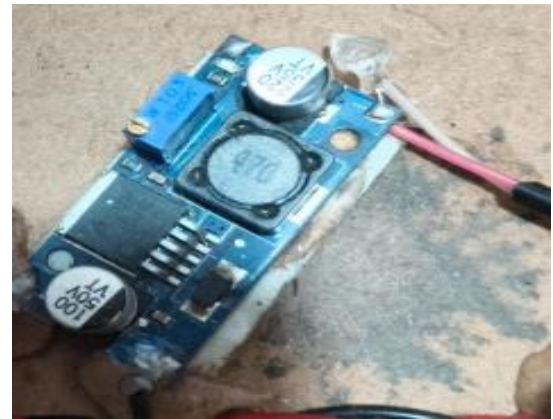
Fig. 19. LM2596 DC-DC Buck Converter Module
