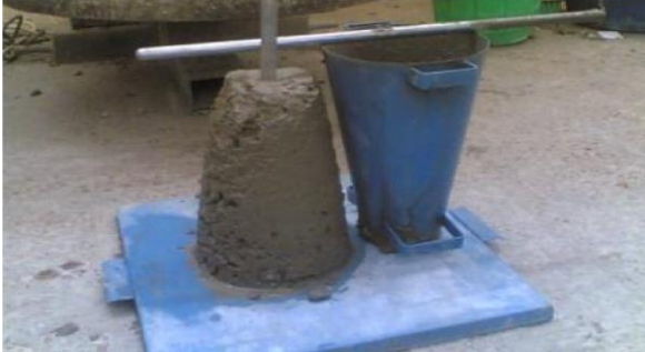
FIG: 2 SLUMP TEST
