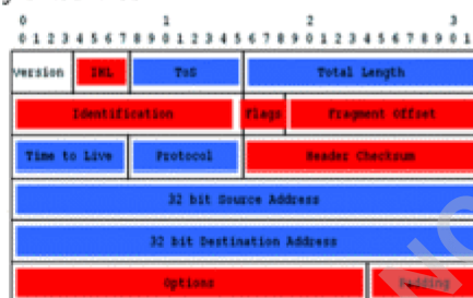
Fig.4. IPv4 Header Format
