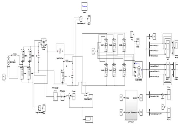
7. SIMULATION FIGURE OF BLDC MOTOR USING IBC
