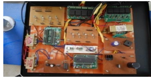
Fig.5. Microcontroller based Controlling arrangement of AMB
