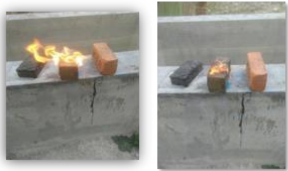
Fig. 4 : Fire Ignition test
