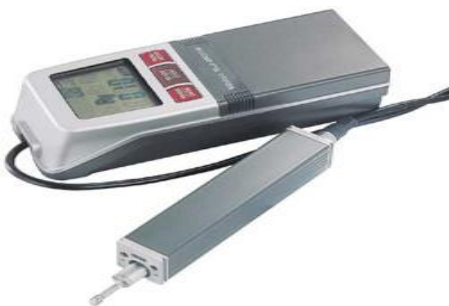
Fig 3. Surface roughness tester (MITUTOYO SURFTEST SJ 201P).
