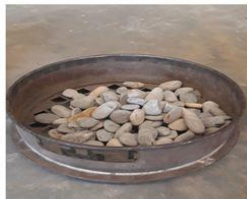
(D)Aggregate size 20-25mm
