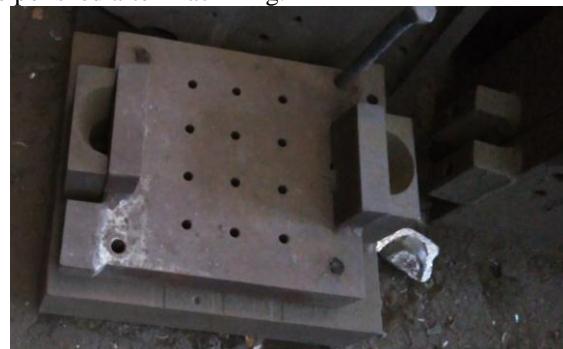
Fig.14. Die for Gravity die casting
