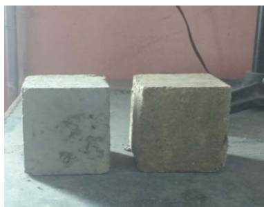
Fig. 6. – Mortar Cubes (70.6 mmx70.6 mmx70.6 mm)
