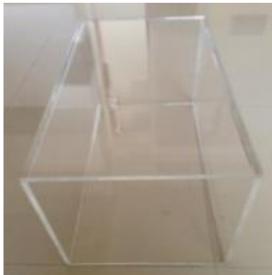
Fig. 26. Plexi Glass Test Section
