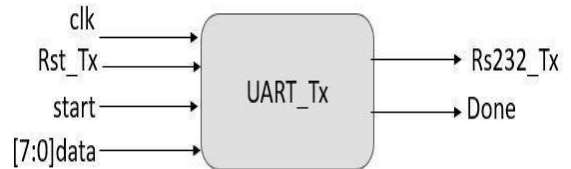
Fig. 2 UART sending module
