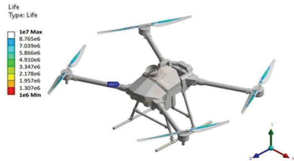
Fig. 17. Life of propeller
