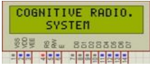
Fig: 5 16x2 LCD pin details
