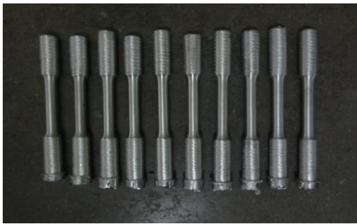
Fig. 1. Tensile test specimens
