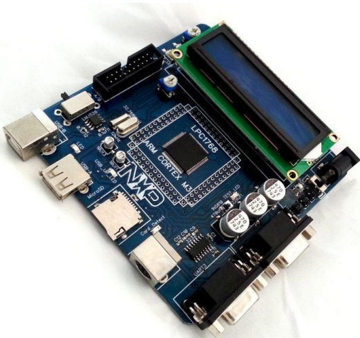
Fig 1: ARM Cortex M3 (LPC1768)
