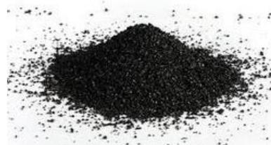
Fig. 1. Copper slag
