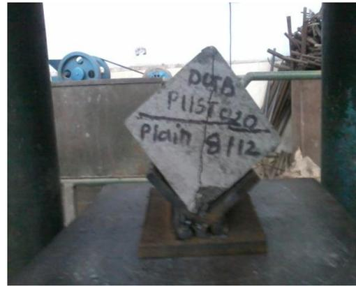
**“Fig. 2(b) Split tensile test”**
